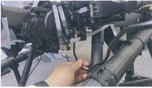
T30 调参接口在飞行器机头右侧
