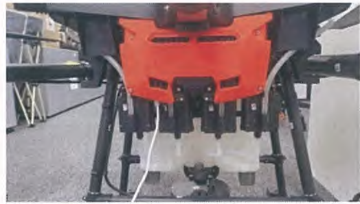
T20 调参接口在飞行器机头左下角
