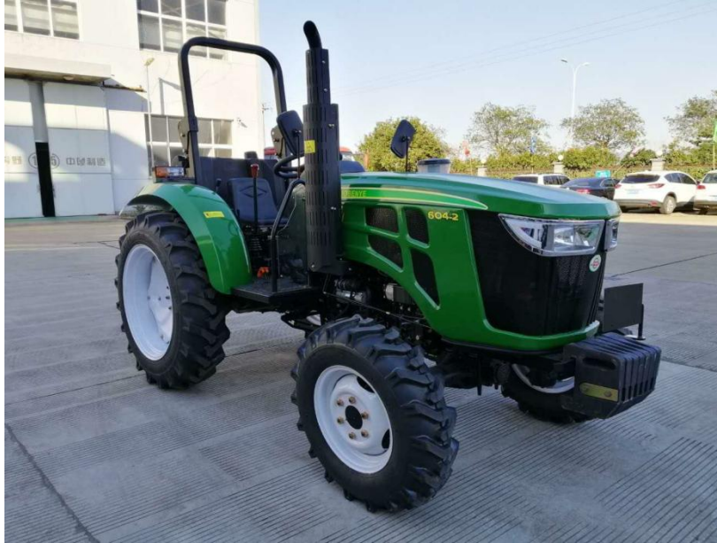
图 1 604-2 型轮式拖拉机（选装 4D27ZT32/604 型发动机）
