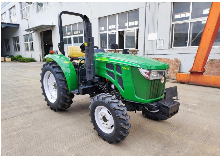
图 1 604-2 型轮式拖拉机（选装 4D27ZT32/604 型发动机）
