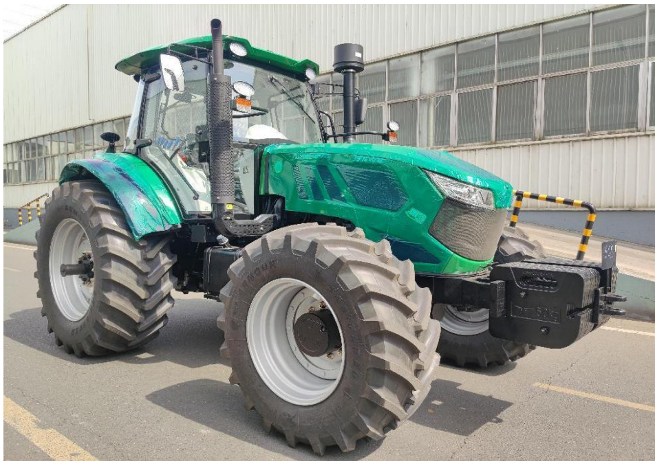
CFK2404 型轮式拖拉机（配置 CF8F270 发动机）
