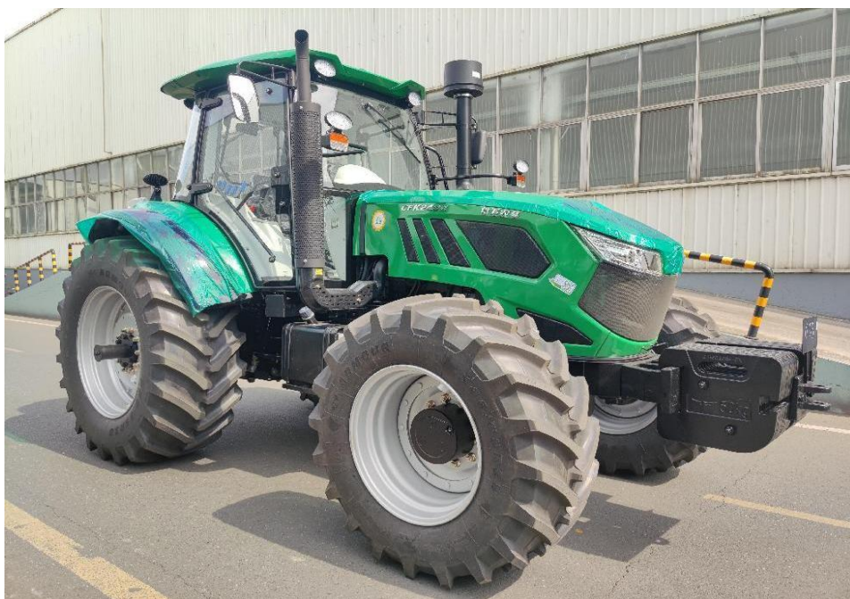
CFK2404 型轮式拖拉机（配置 SC9DK270.1G3 发动机）
