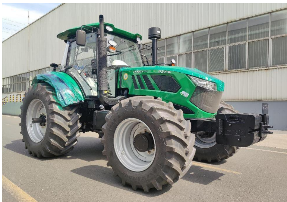
CFK2304 型轮式拖拉机（配置 SC9DK260G3 发动机）
