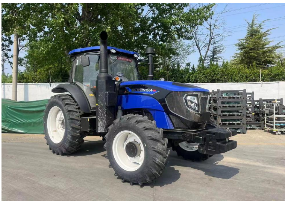
图 4 M1504-5R 型轮式拖拉机（配备 WP6G162E446（国四）型柴油机）
