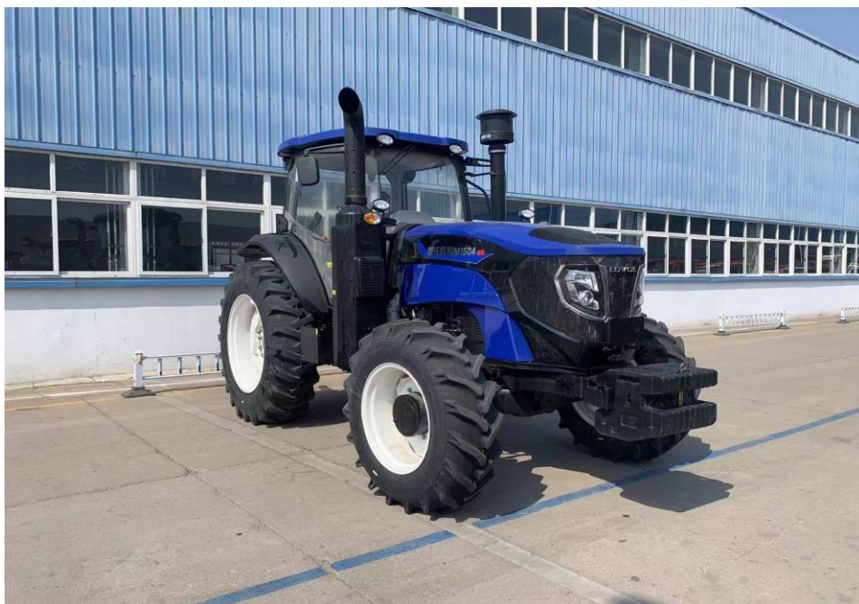
图 2 M1504-5R 型轮式拖拉机（配备 SC7H170G4（国四）型柴油机）
