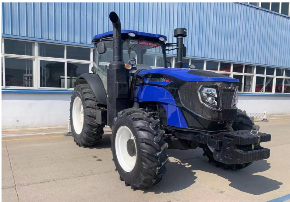
图 3 M1504-5R 型轮式拖拉机（配备 WP7HG163E443（国四）型柴油机）
