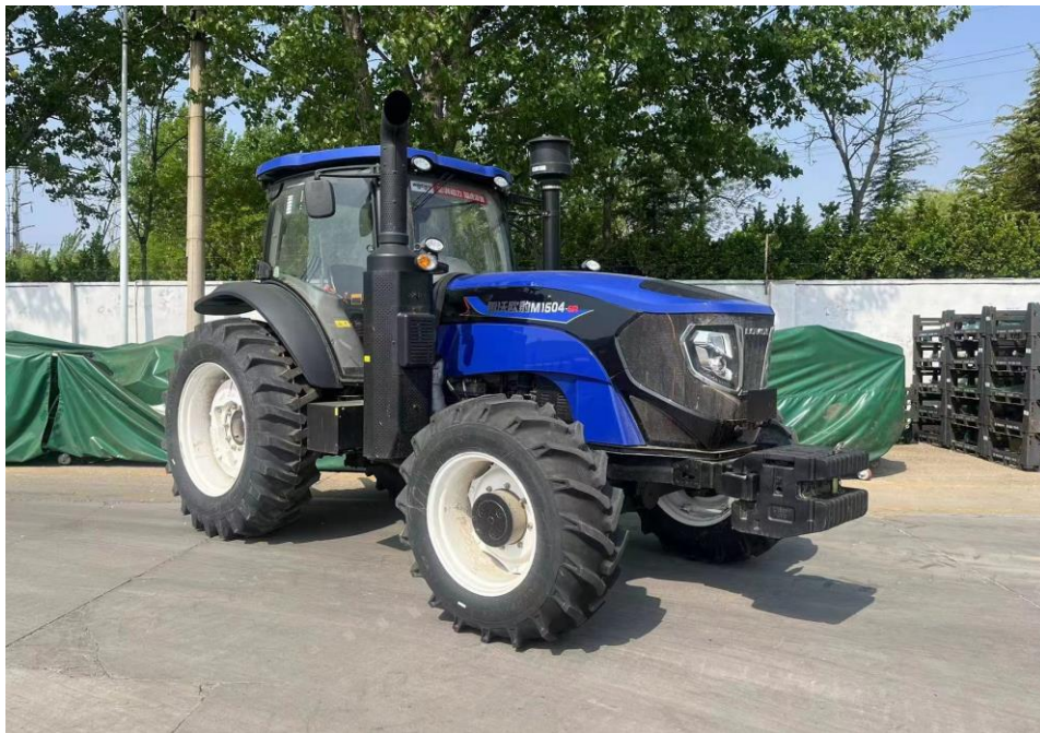
图 1 M1504-5R 型轮式拖拉机（配备 WP7HG163E472（国四）型柴油机）
