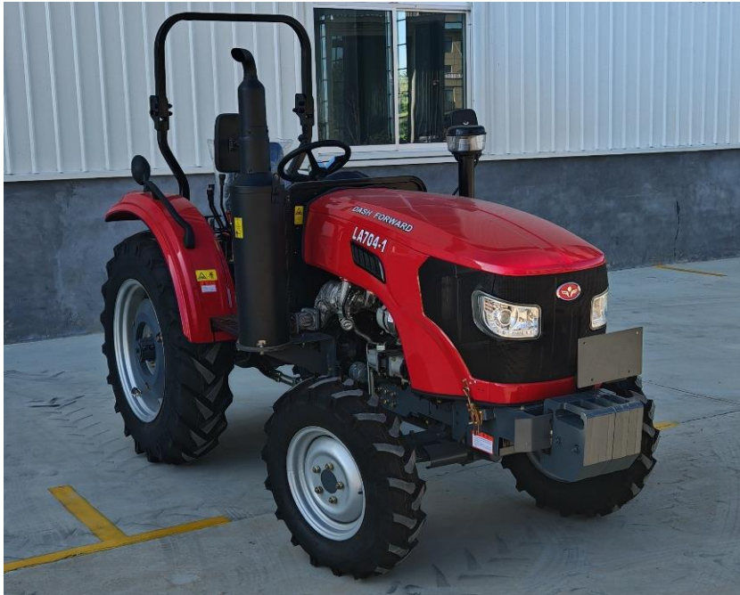
LA704-1 型轮式拖拉机（选装 SDBM4R2（国四）型柴油机）
