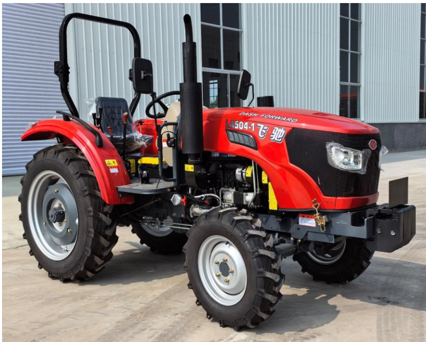
LA504-1 型轮式拖拉机 (选配 Y4110G50A (国四) 型柴油机)
