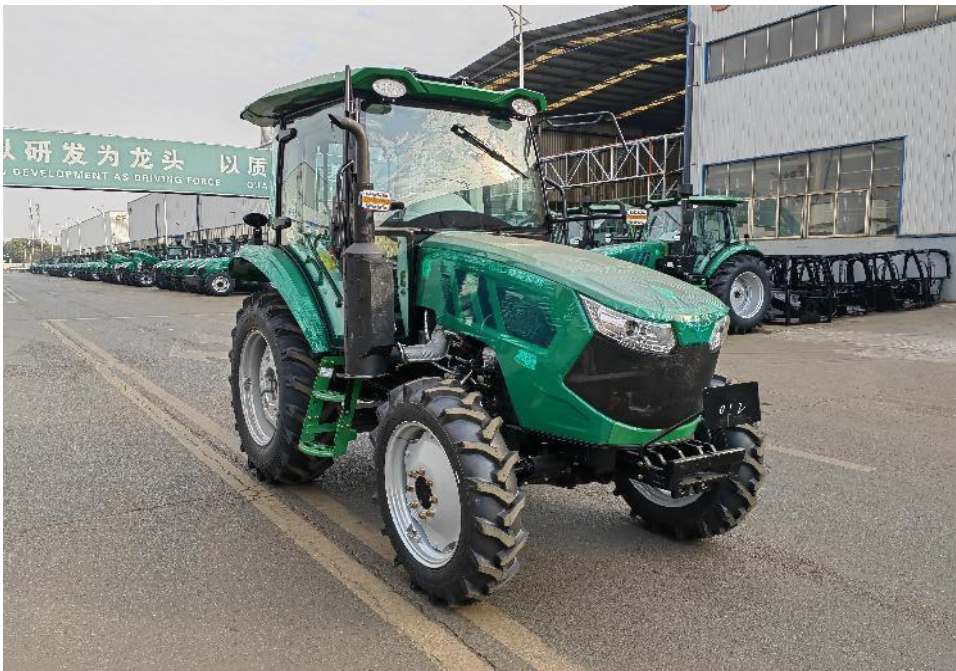
CFE804-X (G4) 型轮式拖拉机（配置 V35-90C41（国四）型柴油机）
