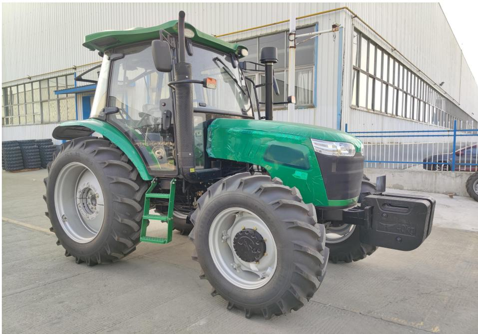
CFM1404-X 型轮式拖拉机 (配置 CF5F140-T 发动机)
