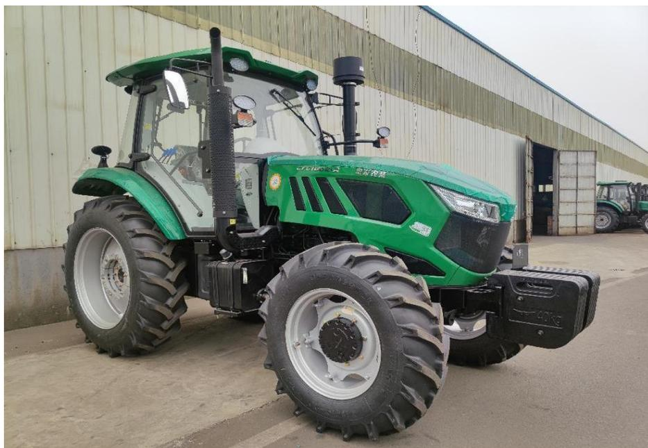
CFG1604-A 型轮式拖拉机（配置 CF8F180 发动机）
