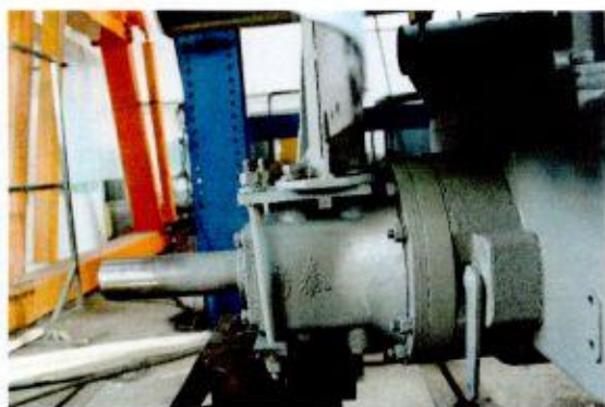
图2 防翻架右侧安装于后轴壳体的形式 (前 视)
