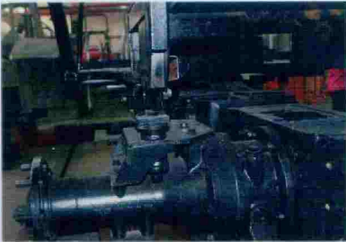
图2 防翻架左侧安装于后桥的形式 (后视)
