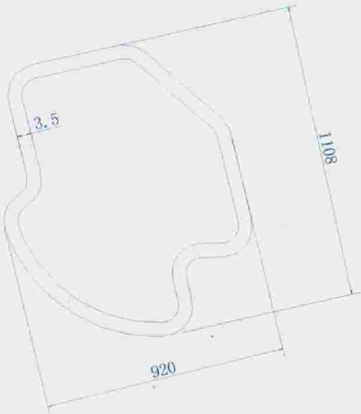
图4-7 异形钢管结构剖面图
