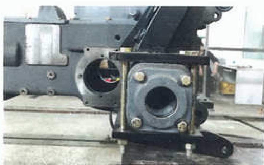
图3 防翻架左侧安装于后轴壳体的形式 (侧 视)
