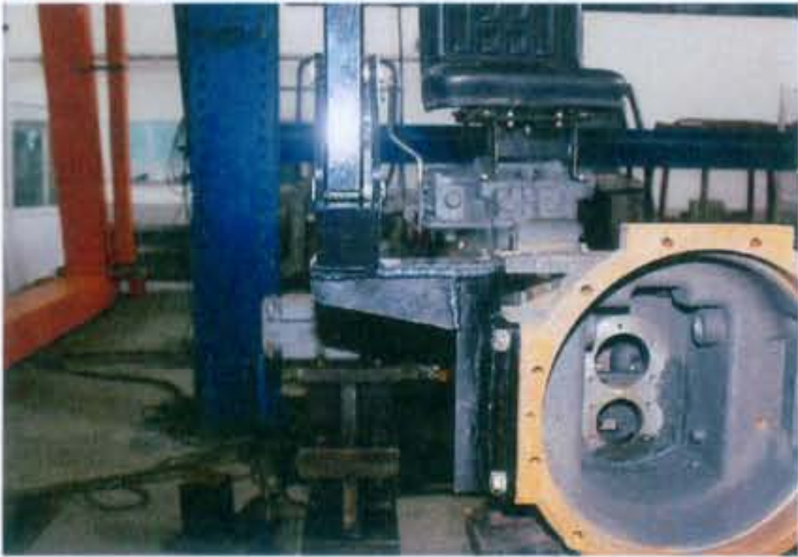
图 2 防翻架右侧安装于壳体的形式 (前视图)
