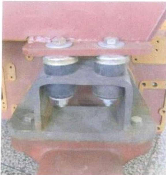
图2 驾驶室左侧安装于后轴的形式
