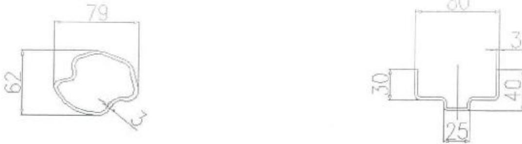
图 4-8 驾驶室前立柱、中立柱型材截面图
