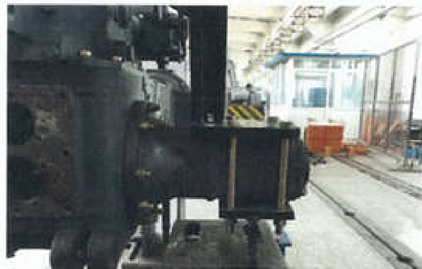
图 2 防翻架右侧安装于后轴壳体的形式 (后 视)
