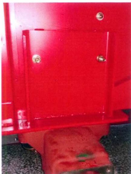
图 2-1 防翻架安装于后轴的形式 (侧视)
