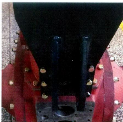
图 4 后部框架安装于后轴壳体的形式 (后视)
