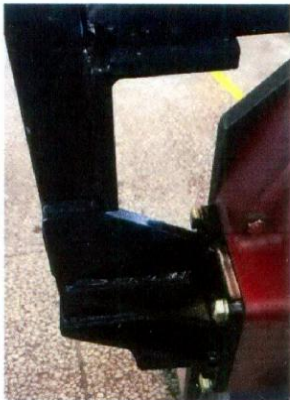
图 3 防翻架安装于壳体的形式 (后视)
