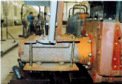
图 3 防翻架左侧安装于后桥壳体的形式 (后视)
