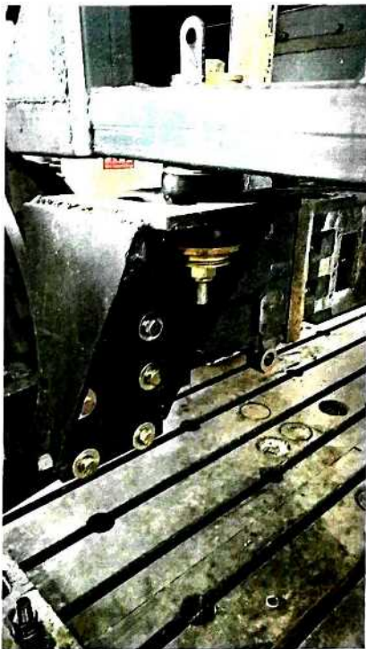
图 2-1: 防翻架前部安装于壳体的形式图
