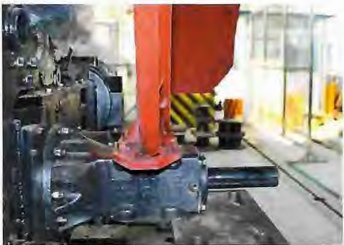
图 3 防翻架右侧安装于后桥壳体的形式 (后 视)
