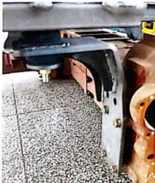
图 2-2 驾驶室地板安装于壳体的形式 (前视)
