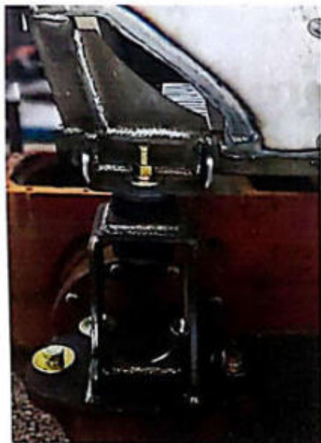
图 2-1 驾驶室左侧安装于后轴的形式 (侧视)
