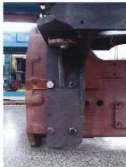
图 2-2 地板安装于壳体的形式 (侧视)
