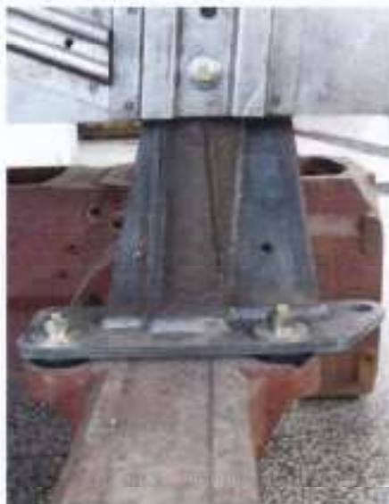
图 2-1 防翻架安装于后轴的形式 (侧视)
