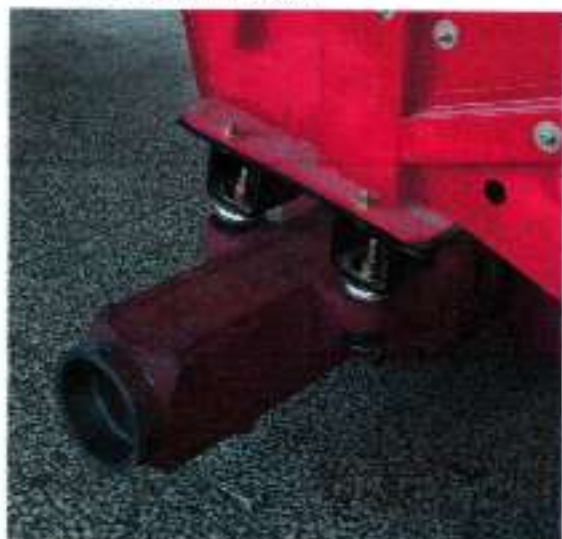
图 2-1 防翻架右侧安装于后轴的形式 (侧视)
