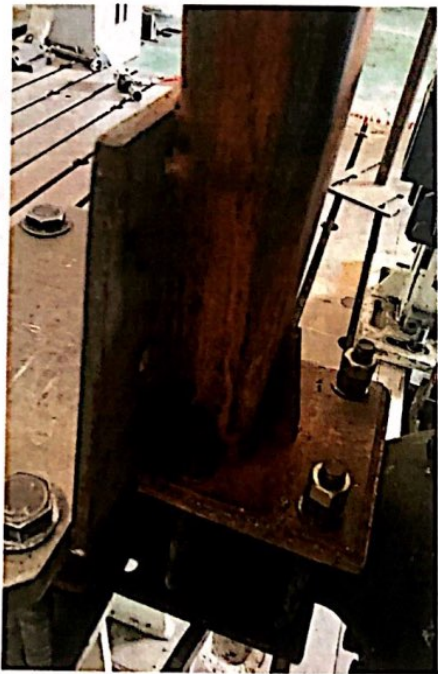
图 2：防翻架安装于半轴壳体形式
