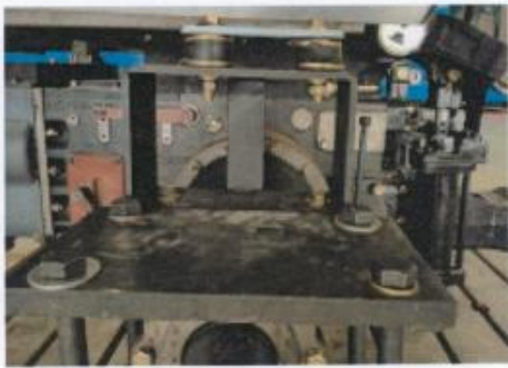
图 3 驾驶室后部左侧安装于后轴的形式 (侧视)
