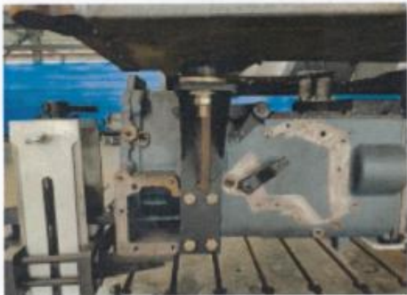
图 2 驾驶室前部左侧安装于壳体的形式 (侧视)
