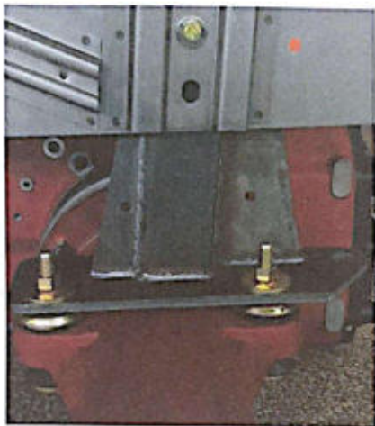
图 2 防翻架安装于后轴的形式 (侧视)
