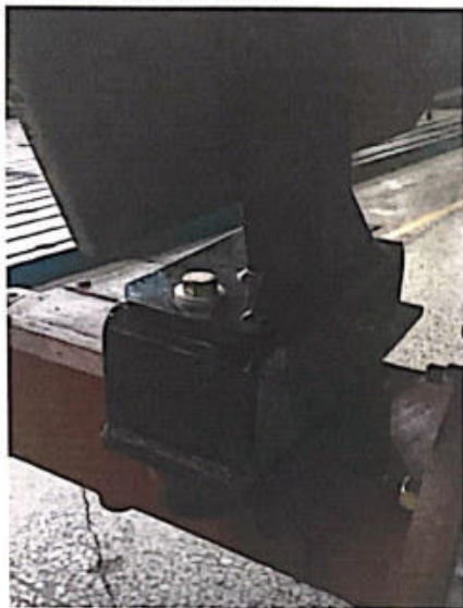
图 2 驾驶室左侧安装于后轴的形式 (后视)
