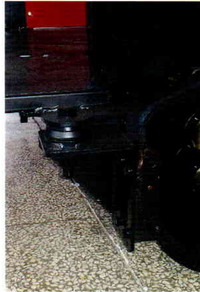
图 2-2 驾驶室地板安装于壳体的形式 (前视)
