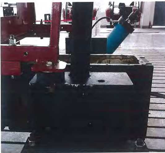
图2 防翻架下部左侧安装于壳体的形式 (侧 视)
