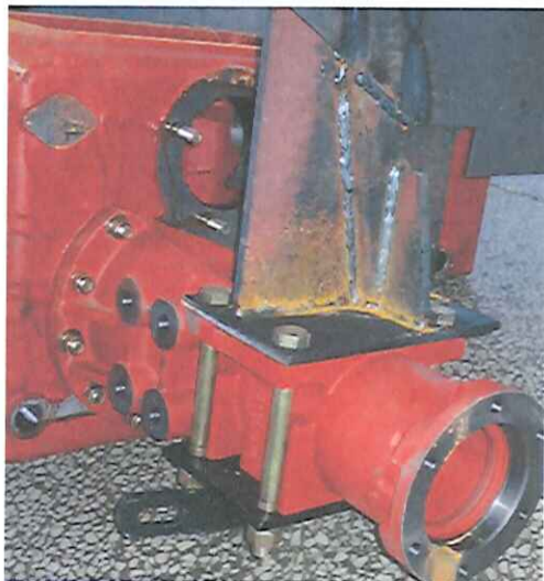
图 2-1 防翻架右侧安装于后轴的形式 (后视)
