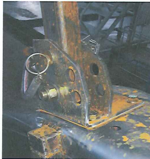
图 2-2 防翻架安装于挡泥板的形式 (侧视)
