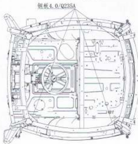
图4-4 驾驶室顶部框架结构示意图
