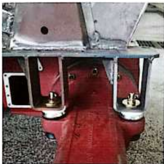
图 2-1 驾驶室左侧安装于后轴的形式 (侧视)
