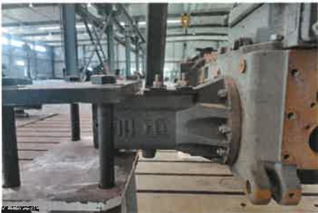
图 2 防翻架左侧安装于后轴的形式
