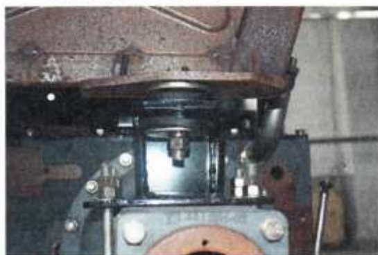
图 2 防翻架左侧安装于后桥壳体的形式 (侧视)
