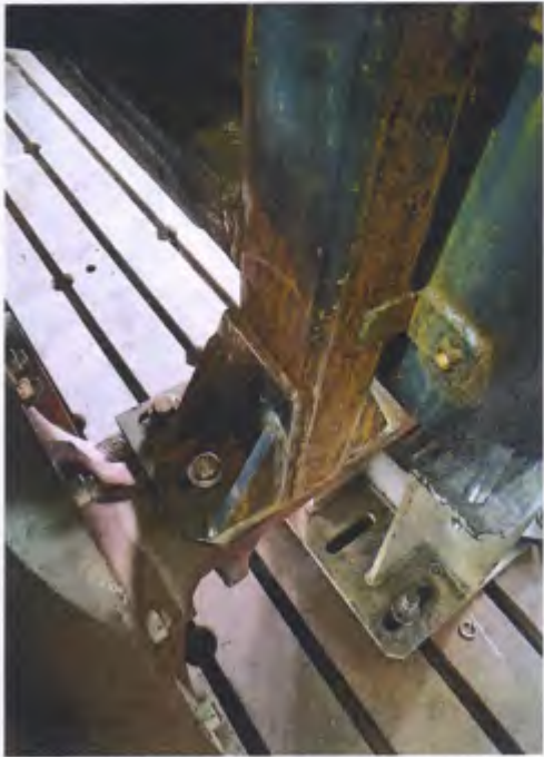
图 2-2: 防翻架后支架安装于半轴壳体形式
