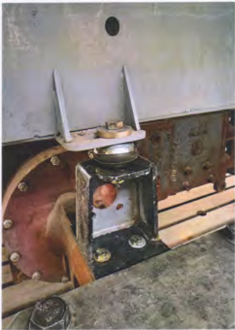
图 2-2: 驾驶室后侧安装于半轴壳体的形式
