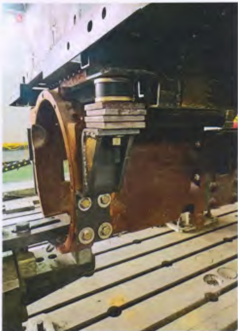
图 2-1: 防翻架前支架安装于变速箱壳体形式
