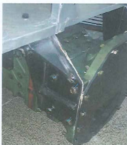
图 3 驾驶室地板安装于壳体的形式 (侧视)
