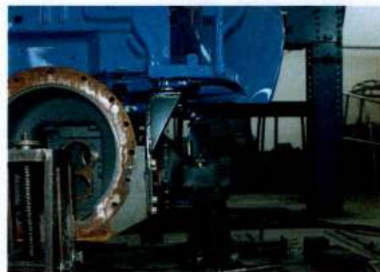
图 3 座箱前部左侧安装于壳体的形式 (前 视)
