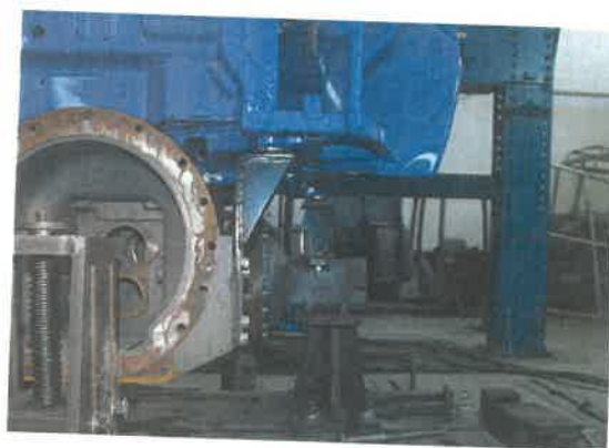
图 3 座箱前部左侧安装于壳体的形式 (前 视)
