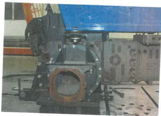
图 2 防翻架后部右侧安装于后桥的形式 (侧 视)
