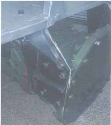
图 3 驾驶室地板安装于壳体的形式 (侧视)
