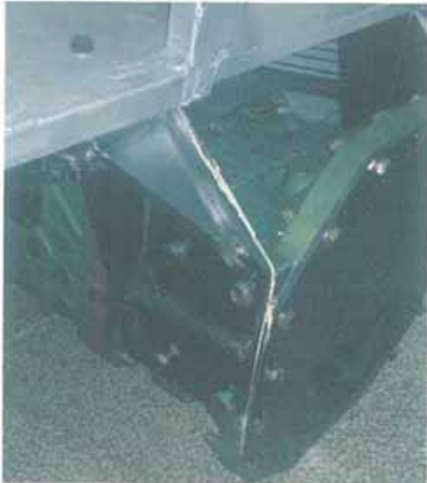
图 2-2 驾驶室地板安装于壳体的形式 (侧视)
