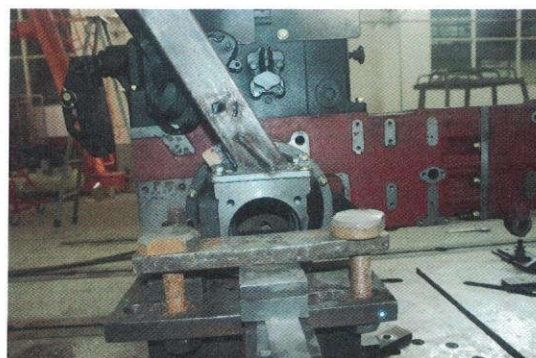
图3 防翻架右侧安装于后轴壳体的形式 (侧 视)
