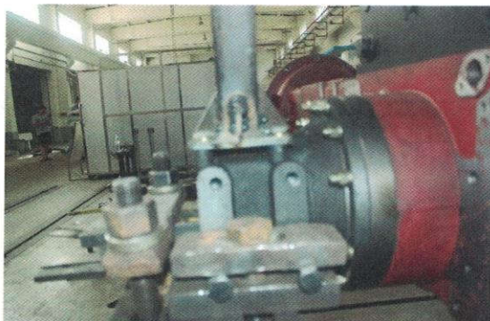
图2 防翻架左侧安装于后轴壳体的形式 (后 视)
