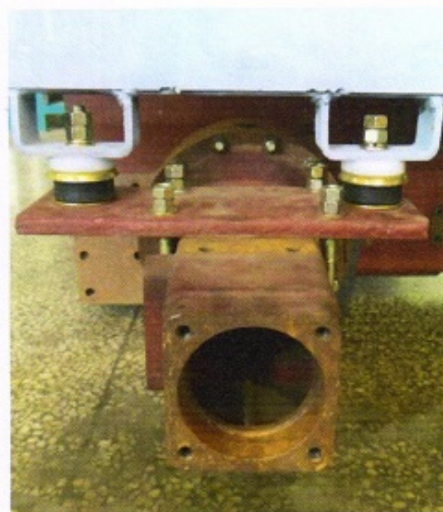
图 3 防翻架安装于后轴的形式 (侧视)
