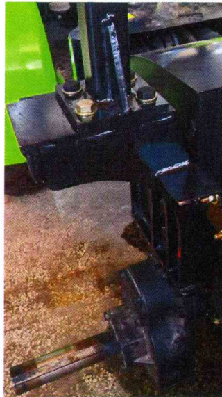
图 4 后部框架安装于壳体的形式 (后视)
