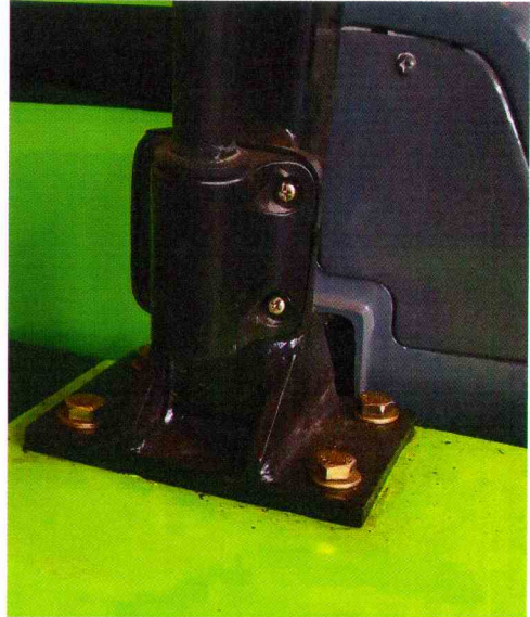
图 3 防翻架上下连接处的形式 (侧视)
