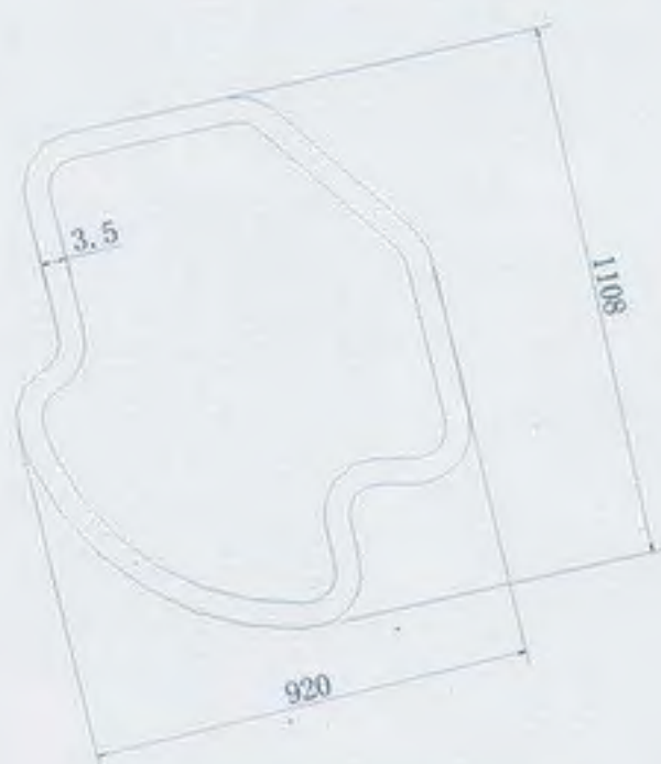
图4-7 异形钢管结构剖面图
