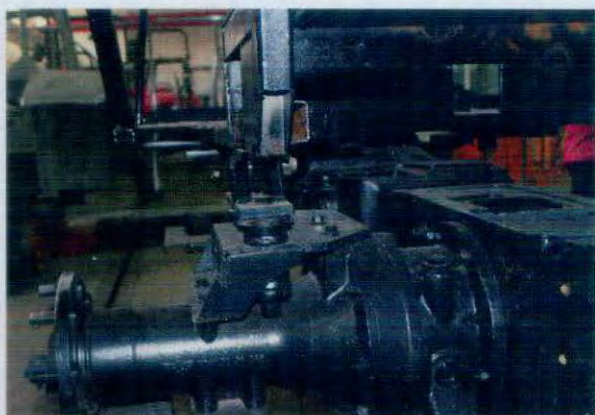
图2 防翻架左侧安装于后桥的形式 (后视)
