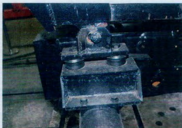
图3 防翻架右侧安装于后桥的形式 (右视)
