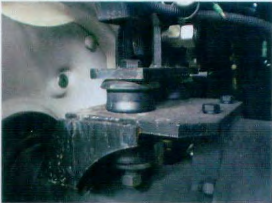
图 2 驾驶室后部左侧安装于后轴的形式 (后视)
