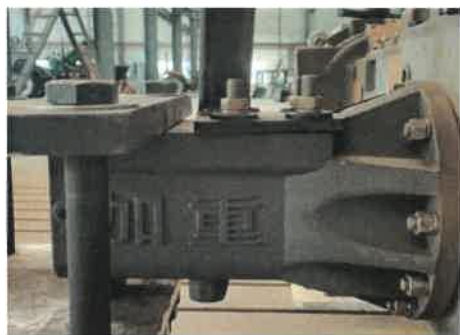
图 2 防翻架左侧安装于后轴的形式 (侧视)
