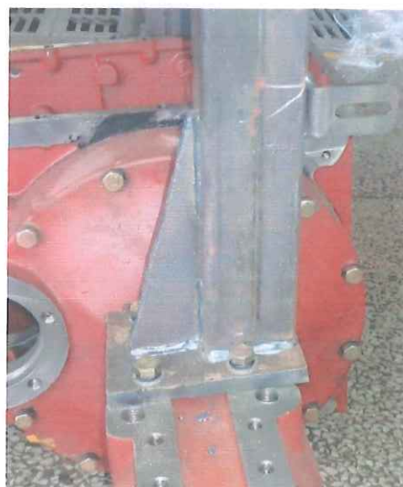
图 2-2 防翻架左侧安装于后轴的形式 (侧视)
