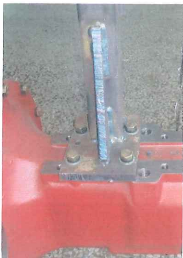
图 2-1 防翻架左侧安装于后轴的形式 (前视)
