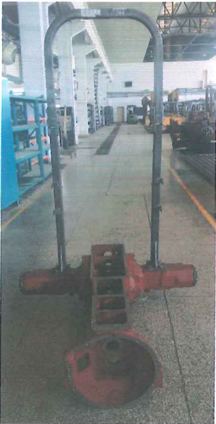
图 3 650.46.001A 拖拉机防翻架照片
