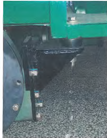
图 3 防翻架地板安装于壳体的形式 (前视)
