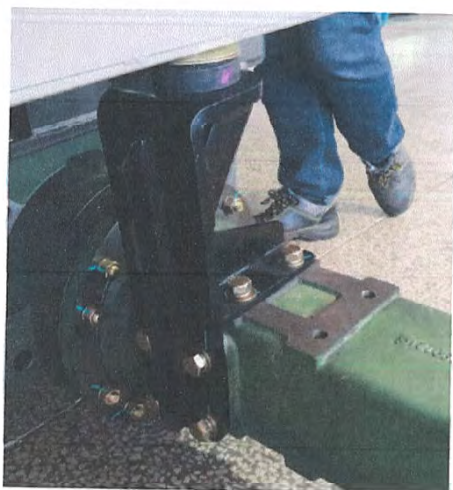
图 2 驾驶室左侧安装于后轴的形式 (前视)
