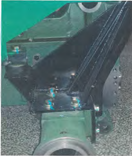
图 2 防翻架左侧安装于后轴的形式 (侧视)
