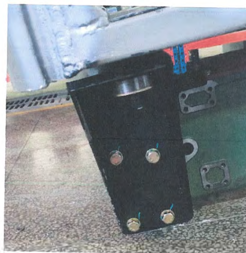
图 3 驾驶室地板安装于壳体的形式 (侧视)
