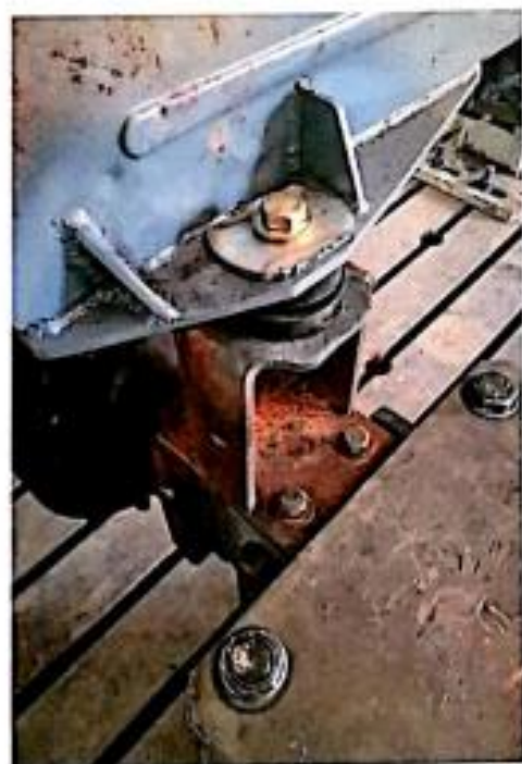
图 2-2: 防护装置后部安装于壳体形式
