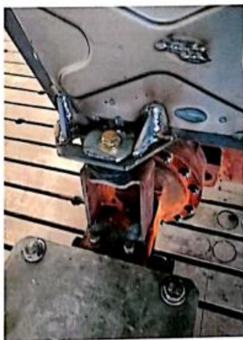
图 2-2: 防翻架后部安装于半轴壳体形式
