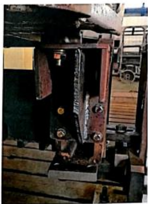
图 2-1: 防护装置前部安装于壳体形式
