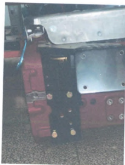
图 3 防翻架地板安装于壳体的形式 (侧视)
