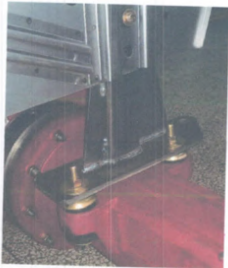
图 2 防翻架左侧安装于后轴的形式 (前视)
