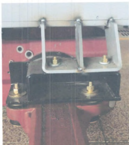
图 2 驾驶室左侧安装于后轴的形式 (侧视)
