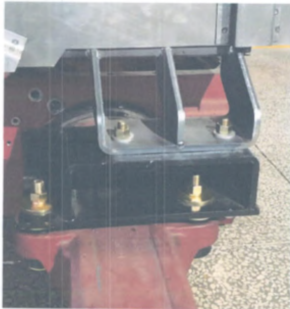
图 2 防翻架安装于后轴的形式 (侧视)
