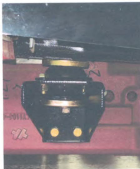
图 3 防翻架地板安装于壳体的形式 (侧视)
