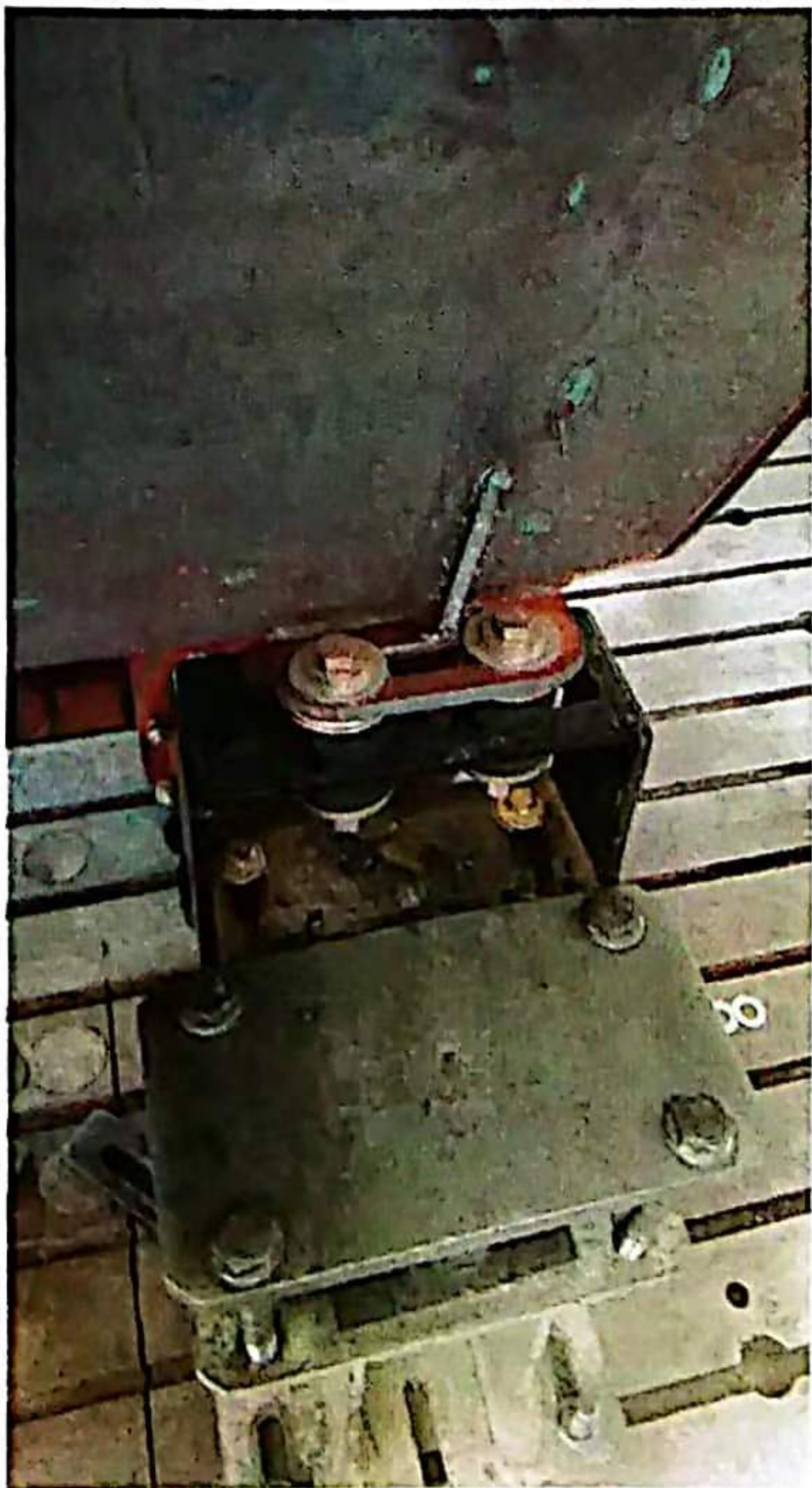
图 2-2: 驾驶室后侧安装于半轴壳体的形式
