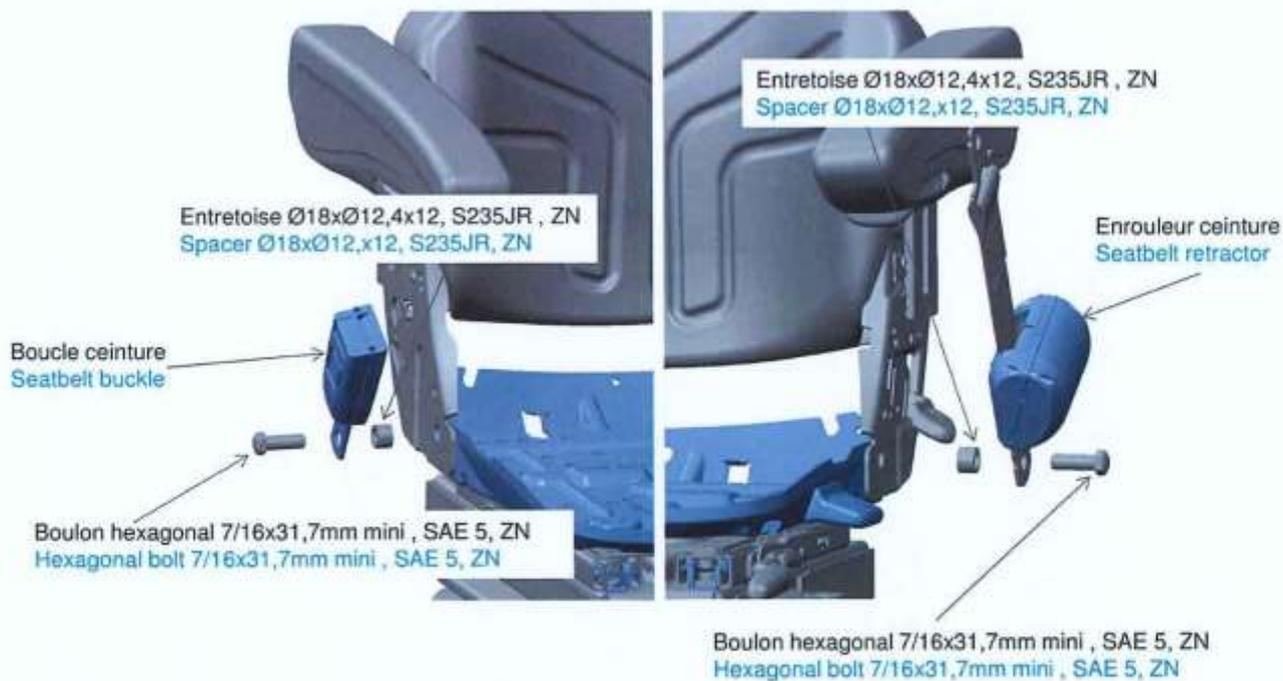
Montage ceinture GRAMMER MSG85/731 et MSG95G/731
