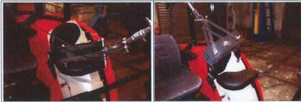
结论：在测试过程中，没有任何结构破坏或座椅、座椅调节装置或其他锁止的脱离。座椅和安全带满足 OECD 的要求。
