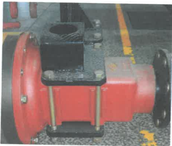
图 2 防翻架左侧安装于后轴的形式 (前视)
