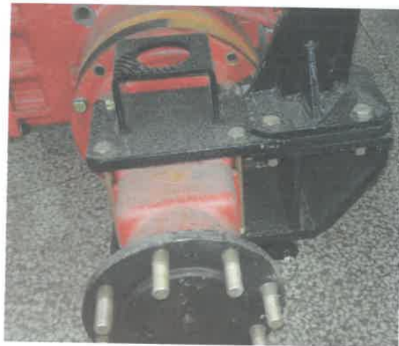
图 3 防翻架左侧安装于后轴的形式 (侧视)
