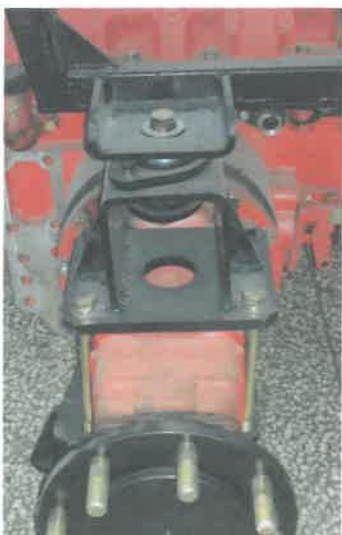
图 2 驾驶室右侧安装于后轴的形式 (侧视)
