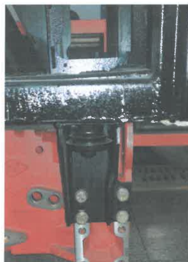
图 3 驾驶室地板安装于壳体的形式 (侧视)
