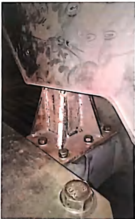
2-2: 防翻架后支座安装于后轴的形式
