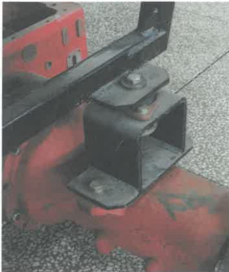
图 2 驾驶室左侧安装于后轴的形式 (前视)
