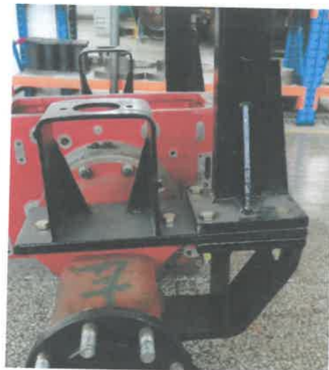
图 3 防翻架左侧安装于后轴的形式 (侧视)
