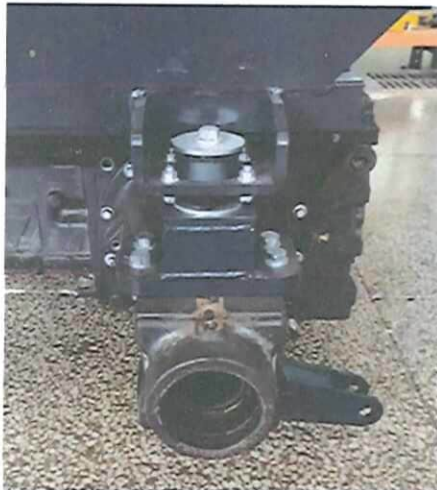
图 2 防翻架左侧安装于后轴的形式 (侧视)
