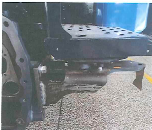
图 3 防翻架地板安装于壳体的形式 (前视)
