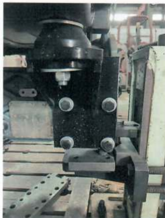
图 3-1: 防护装置前侧安装于壳体形式
