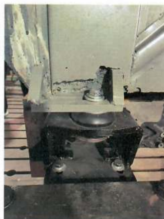
图 3-2: 防护装置后侧安装于半轴壳体的形式
