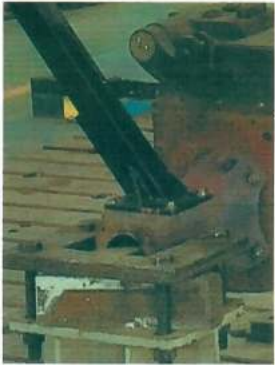
图 2: 防翻架安装于半轴壳体的形式
