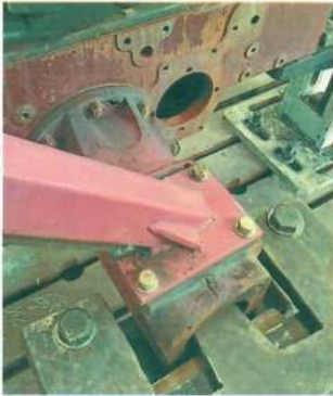
图 2: 防翻架安装于半轴壳体的形式
